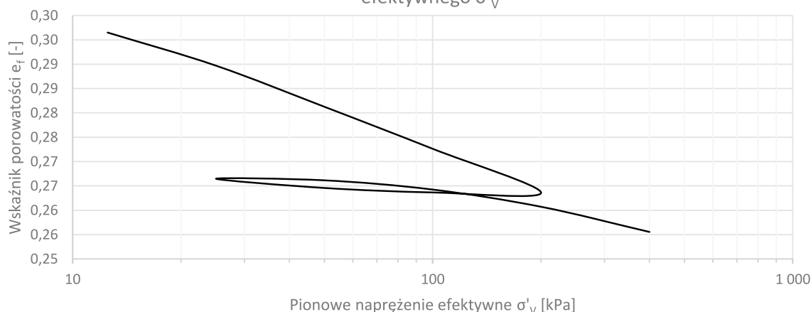
Wykres zależności wskaźnika porowatości e_f od pionowego naprężenia efektywnego \sigma'_v
